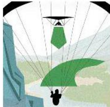
Soaren am Hang: Das Fluggerät mit dem Hang an der linken Seite weicht nach rechts aus.
